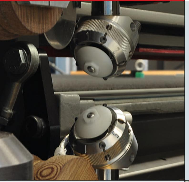
■ L'innovativo cambio utensile rotante "Click & Cut" permette di avere tutti gli utensili disponibili direttamente sulle teste di taglio: ruotando il supporto multi-utensile si "parcheggia" la rotella in uso e si "posiziona" quella nuova, a tutto vantaggio del tempo ciclo.
