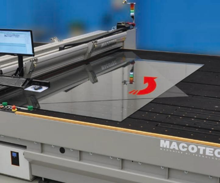
■ Dispositivo (brevettato) per la rotazione ed attestatura automatica dei traversi senza la necessità di intervento né consenso dell'operatore. Esecuzione automatica tagli W.
